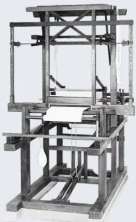
佐吉发明的第一台织机： 丰田式木制人力织机 (丰田产业技术纪念馆提供)
